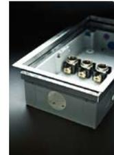
MULTIBOX UPB Nach dem Montieren der Rohre kann die MULTIBOX einbetoniert werden. Sobald ausgeschalt ist, wird der Styroporblock entfernt und die Sicherungselemente eingebaut und angeschlossen. Den Abschluss bilden der Frontrahmen und der Deckel.
