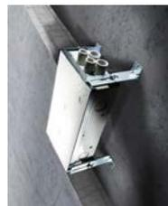
MULTIBOX UPB Die MULTIBOX UPB lässt sich mit einfachsten Mitteln direkt einbetonieren. Mit wenigen Handgriffen ist die UPB-Version auf der Schalung montiert und mit den Flügelschrauben auf die Wanddicke eingestellt.
