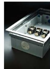
MULTIBOX UPB Nach dem Montieren der Rohre kann die MULTIBOX einbetoniert werden. Sobald ausgeschalt ist, wird der Styroporblock entfernt und die Sicherungselemente eingebaut und angeschlossen. Den Abschluss bilden der Frontrahmen und der Deckel.
