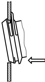
Socket im oberen Rand des Montageausschnitts einsetzen.
