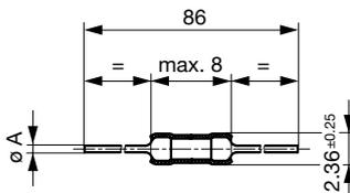
$I_n \leq 10\text{ A}$ :  $\varnothing A = 0.62\text{ mm}$
